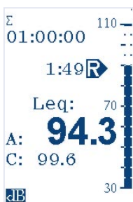
Das Display des Schallpegelmessers zeigt sowohl den A- und den C- oder Z-bewerteten Pegel gleichzeitig
