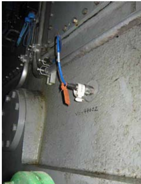
Ein Beschleunigungsmesser (links) ist auf dem Rahmen eines Ethylen-Kompressors (rechts) montiert
