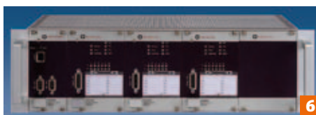
6 Ein VC-6000 Baugruppenträger besteht aus einem Communication Modul (links) und 1-4 Überwachungsmodulen. Spannungsversorgungsmodule (optional redundant) können im gleichen, oder in einem dafür vorgesehenen Baugruppenträger untergebracht werden.
